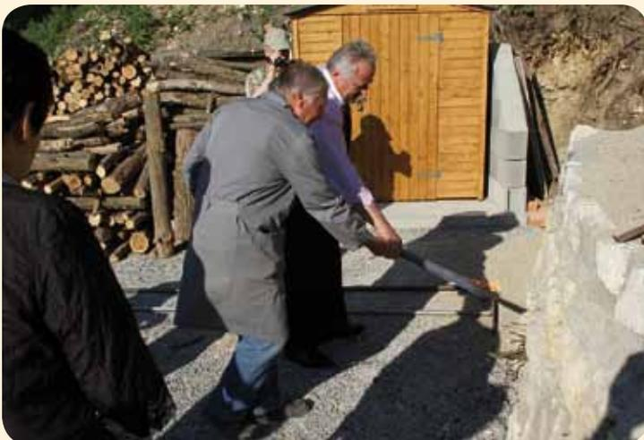
Nach einer einwöchigen Abkühlphase konnte der Branntkalk aus dem Ofen geräumt werden.
